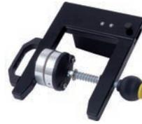
Pour mesurer les résistances de fuite des dossiers des chaises ESD, avec caoutchouc de contact avec particules d'argent R < 5 Ohm.
