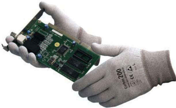
Des gants ESD sont utilisés pour dissiper l'électricité statique.
