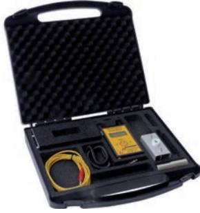
EFM®51 avec support conducteur et tête de mesure MK 51. En attachant la tête de mesure MK 51 l'électromètre EFM®51 peut être utilisé pour la mesure de vérification de la tension du corps (test de marche) selon IEC 61340-4-5. La tête de mesure MK 51 est spécialement calibrée à EFM®51. Les valeurs "PEAK" positive et négative de la tension du corps mesurée sont affichées.
