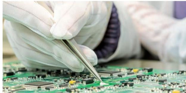
Les gants en polyester avec des fibres conductrices en carbone intégrées ont de bonnes valeurs de dissipation et sont également appropriés pour l'utilisation dans des salles blanches.
