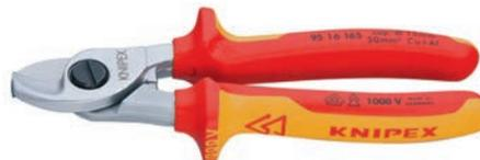
Coupe-câbles testé VDE, tranchants trempés, meulés avec précision, coupe nette et sans écrasement. Coupe facile avec prise d'une seule main, protection contre les pincements et charnière vissée réglable, sécurité automatique.
