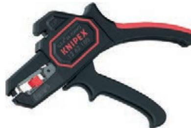
Outil standard compact avec tête étroite, pour conducteurs unifilaires, multifilaires et fils fins, s'adapte automatiquement aux différentes sections de fils, très confortable grâce à sa forme pratique et au poids faible, butée longitudinale, avec coupe-fils pour conducteurs jusqu'à 2,5 mm<sup>2</sup>, couteaux facilement interchangeables, boîtier en plastique, renforcé de fibres de verre, poignée avec zone en plastique souple ergonomique.
