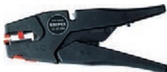
pour des conducteurs unifilaires, multifilaires et fils fins isolés par la matière plastique ou en caoutchouc, s'adapte automatiquement aux différentes sections de fils, profondeur de coupe ajustable, mécanique souple, couteaux et mâchoires de serrage en plastique, avec coupe-fils (pour conducteurs multifilaires jusqu'à 10mm<sup>2</sup>, unifilaires jusqu'à 6 mm<sup>2</sup>), poids faible, boîtier en plastique, renforcé de fibres de verre
