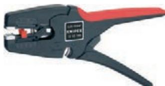
Adaptation complètement automatique aux différentes épaisseurs d'isolation dépendantes des sections de fils, remise automatique de la profondeur des coupes, mâchoires de serrage en acier avec tranchants intégrés, avec coupe-fils (pour conducteurs multifilaires jusqu'à 10mm<sup>2</sup>, unifilaires jusqu'à 6 mm<sup>2</sup>), boîtier en plastique, renforcé de fibres de verre
