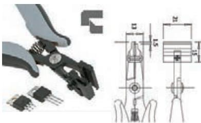
Pince coupante, longueur des segments réglable de 1,5 mm jusqu'à 10 mm max. Version ESD DIN EN 61340-5-1
