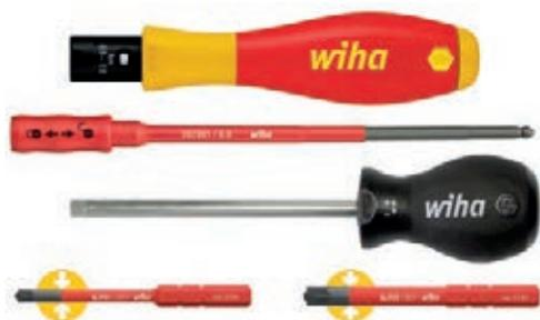
Jeu de tournevis dynamométriques Torque à 5 pièces. Pour le vissage contrôlé à proximité de pièces sous tension jusqu'à 1 000 V AC. Manche de tournevis dynamométrique est réglable de manière continue dans la plage 1,0 - 5,0 Nm avec outil de réglage Torque-Setter (inclu dans la livraison). Protection isolante directement moulée sur les embouts dont la partie frontale est complètement intégrée dans l'embout.
