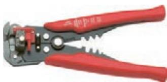
pour dénuder, couper et sertir des fils; lames en acier trempées pour une haute longévité; dénudage automatique des fils sans réglage; sertissage des bornes isolées et non-isolées; micro bouton de réglage permet le dénudage des fils de moins de 0,2 mm<sup>2</sup>.
