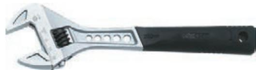
avec mâchoires Sure-Drive - applique le couple plutôt sur le pan de l'écrou plutôt que sur les angles, évitant ainsi de les arrondir; en acier au chrome-vanadium, mat chromé - particulièrement robuste et résistant à la corrosion; poignée souple et confortable; échelle métrique et impériale / ouverture jusqu'à 18% plus grande que les modèles standard; avec indication du sens de rotation pour ne pas endommager les vis.
