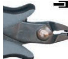
Pince spéciale pour électronique. Dans une seule opération le composant est coupé, coudé et au même temps bloqué sur le circuit imprimé.
