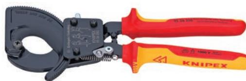
Coupe-câbles testé VDE, tranchants trempés, meulés avec précision, coupe nette et sans écrasement. Entraînement par couronne dentée à 2 positions pour une coupe facile. Faible effort nécessaire grâce à un rapport de démultiplication propice, protection contre les pincements, charnière vissée réglable, sécurité automatique.
