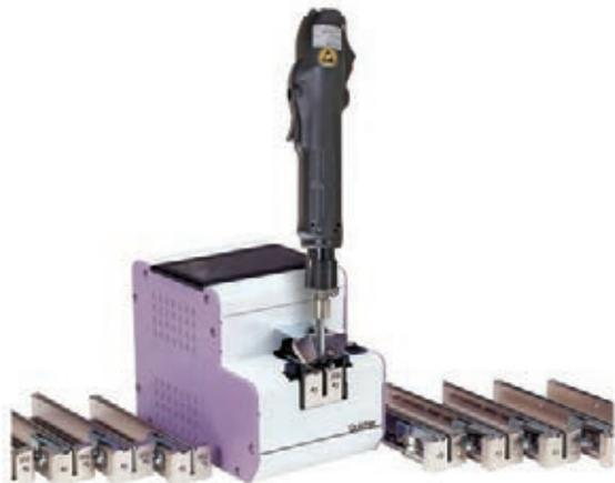
La série NSB a un système d'alimentation de précision des vis qui peut être utilisé pour de très petites vis. Pour la série NSR la vis est exemptée de manière qu'elle peut être prise p.ex au sein d'un robot de vissage en moyen d'un tournevis p.ex. avec un embout à vide.
