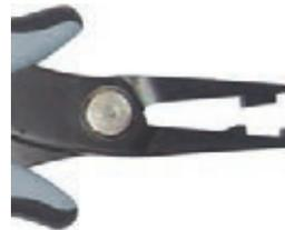
Spécialement conçue pour déformer des fils en forme „L“ et pour couper les composants restants
