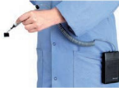
Système de manipulation à vide portable, alimenté par pile (9V Alkaline, 8 heures de durée de vie), avec tuyau spiralé de 1,2 m (Ø = 1,6 mm), jeu de 7 buses à vide VCS-7-B, pipette à vide V3020-RF-1/16, avec ceinture / clip de poche au boîtier, poids 156g.
