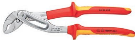
isolée, testée VDE, haute stabilité, autobloquante sur tubes et écrous, ergot de protection évitant les pincements, effet de levier pratique pour un effort amplifié optimal, surfaces de préhension à dents spécialement trempées (61 HRC), acier électrique au chrome-vanadium
