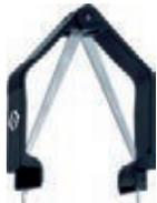
universellement utilisable pour tous les composants PLCC (20 - 124 broches); en plastique conducteur; crochet en acier inoxydable, trempé; pour l'utilisation ESD; avec ressort pour une ouverture automatique.
