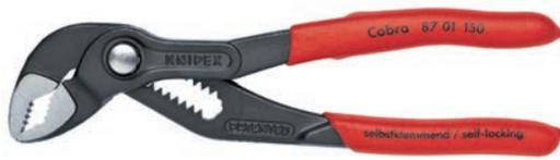
Réglage confortable et vite à même la pièce par simple pression du bouton, réglage précis pour un ajustage parfait, grande stabilité, autobloquante sur la pièce prévenant un glissement, ergot de protection empêchant les pincements, surfaces de préhension à dents spécialement trempées (61 HRC), acier électrique au chrome-vanadium.
