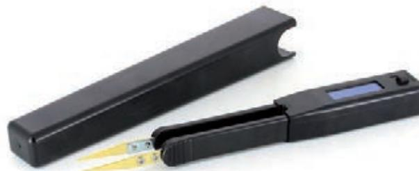
Appareil de mesure automatique et adaptif pour mesurer LEDs CMS avec des brucelles précises et plaquées or. Smart Tweezers™ Iskra™ facilite la mesure de différents types de LEDs déjà montés sur une platine. Opération confortable à une seule main, détection automatique de la polarité LED, affichage d'une chute de tension, prérégulation de l'intensité du courant d'essai.
