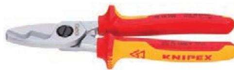
Coupe-câbles testé VDE, tranchants trempés, meulés avec précision, coupe nette et sans écrasement. Faible effort nécessaire grâce à un rapport de démultiplication propice, coupe facile avec prise d'une seule main, protection contre les pincements, charnière vissée réglable, sécurité automatique.
