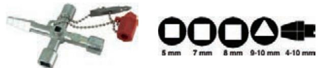
Clé cruciforme universelle pour armoires électriques utilisable pour des systèmes de fermeture dans l'alimentation en électricité, gaz et eau, l'industrie, la climatisation et la ventilation, des armoires électriques etc; avec 4 inserts, carré de 5,7 et 8 mm, triangulaire de 8/9 mm et carré conique pour les tailles de 4 à 10 mm; livrée avec adaptateur pour embout utilisable pour vis tête carrée de 8 mm et double embout pour vis Phillips taille 2 et vis à fente 1,0 x 0,7 mm.
