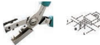
Pour le cintrage à 90° de deux rangées des composants TO 126, 218, 220, des transistors de puissance etc. Réglable au moyen d'une vis.
