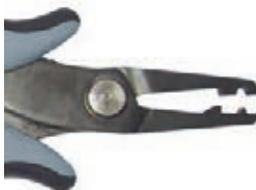
Spécialement conçue pour déformer des fils en forme „C“ et pour couper les composants restants
