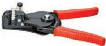
Dénudage doux même des fils fins, les mâchoires de serrage maintiennent le fil lors du dénudage, butée longitudinale pour dénuder des longueurs constantes lors de travaux répétés, ressort de rappel pour ramener la pince dans la position initiale, corps robuste en métal léger.
