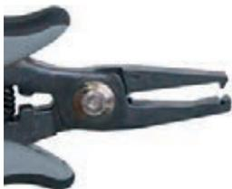
Dans une seule opération le composant est coupé, soudé et au même temps bloqué sur le circuit imprimé.
