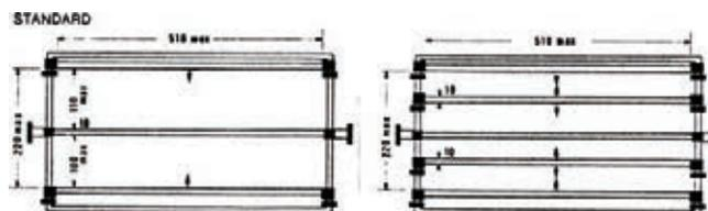
Les supports de circuit imprimé sont équipés d'une barre centrale et 2 rails de guidage réglables.
