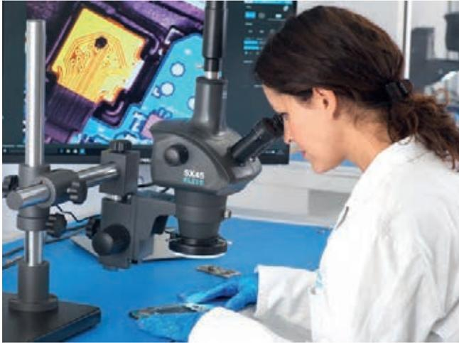
Le microscope zoom stéréo Greenough de haute qualité est utilisable pour une large gamme d'application, impressionne par sa construction robuste et durable et est facile à utiliser. L'objectif produit des images très nettes sur toute la plage du zoom.
