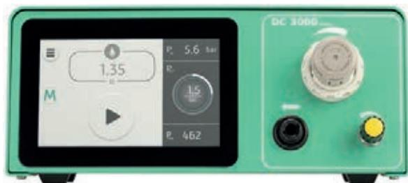
Presque tous les réglages du doseur DC 3000 se font via l'écran tactile. Seulement la pression et la rétention du vide se règle avec le bouton rotatif au casier. La grande mémoire du DC 3000 permet d'enregistrer jusqu'à 64 programmes. Il est possible d'assembler jusqu'à cinq séquences de programmes et de les déroulent l'un après l'autre.
