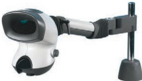
Convient pour des applications à lumière incidente générales avec grossissement x2, x4, x6 ou x8, tâches d'inspection et de manipulation "à main libre" de petites et grandes pièces de tous les domaines techniques, grande flexibilité grâce au support à bras articulé spécialement conçu, pour un seul poste de travail avec montage par serrage ou socle à 3 trous monté sur la table de travail.
