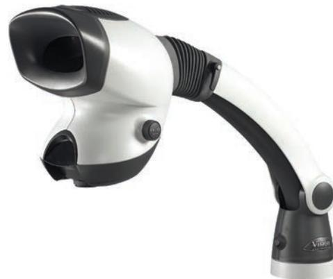
Convient pour des applications à lumière incidente générales avec grossissement x2, x4, x6 ou x8, tâches d'inspection et de manipulation "à main libre" de petites et grandes pièces de tous les domaines techniques, pour un seul poste de travail avec montage par serrage ou socle à 3 trous monté sur la table de travail.
