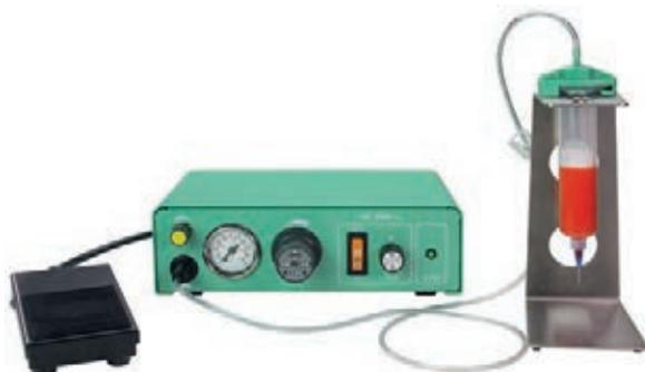
Les doseurs de la série DC270 est sont équipés d'un temporisateur avec lequel un temps de dosage réglable de 0,01 à 30 secondes peut être réglé. Les deux modèles disponibles se distinguent par le dimensionnement de la pression de sortie. Le doseur DC 200 est utilisé pour le contrôle précis du dosage à commande pneumatique, comme le dosage des petites cartouches de 3 - 55 cc. Le régulateur d'air comprimé intégré permet de régler la pression du matériau avec précision.
