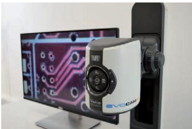
Le microscope numérique EVO Cam II fournit des images parfaitement nettes qui vous aident à documenter et vérifier vos échantillons ainsi qu'à analyser des défauts. Le menu intuitif est disponible dans plusieurs langues. Le grossissement optique jusqu'à 300x et la mise au point automatique intelligente garantissent des images parfaitement nettes et à haute résolution.
