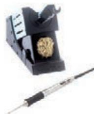
Le fer à souder WMRP atteint sa température de fonctionnement très rapidement. Le changement des pannes à souder est possible sans outil. Grâce au déclenchement de la température immédiate en déposant le fer à souder dans le support de sécurité WMRH, la durée de vie augmente nettement. Convient pour les stations de soudage WMRS, WD 1M, WD 2M et WR 3M.
