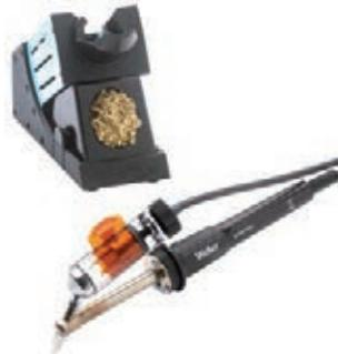
Grâce à sa construction le fer à dessouder DSX 80 permet une posture ergonomique et un travail sans fatigue même en usage intensif. Le collecteur d'étain peut être nettoyé facilement et rapidement. Le vide est activé par presser la commande de doigt intégré dans le manche. Une large gamme de buse et CSF fait de lui un outil universel.
