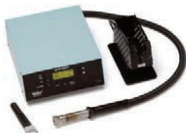
Nécessite 4 - 6 bar d'air comprimé ou de gaz inerte. Electronique de réglage numérique, afficheur LCD, opération manuelle ou automatique, interface RS 232 pour la commande via PC, connexion pour capteur externe, vide de buse maximale -0,6 bar, support de sécurité avec fonction Stop+Go, classe de protection 1.
