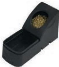
La solution pour les problèmes de nettoyage avec le soudage sans plomb à l'aide de laine spiralée. Le nettoyage grossier de la panne à souder se fait en tapotant la panne contre un bord doux du récipient, le nettoyage fin s'effectue ensuite par raclage ou rotation de la panne à souder dans la laine spiralée.
