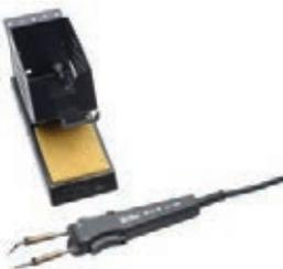
Les brucelles à dessouder WTA 50 ont été spécialement conçues pour dessouder des composants CMS et peuvent être connectées à toutes les stations Temtropic. Deux éléments chauffants chacun avec un capteur de température assurent des températures constantes aux deux branches. Les pannes à souder sont fixées à l'aide de vis de blocage.
