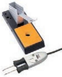
Grâce aux paires de pannes à souder parallèles les brucelles de dessoudage WMRT permettent un soudage et dessoudage précis de très petits composants CMS. En déposant les brucelles de dessoudage dans le support de sécurité WMRTH des pannes à souder réglables sont déclenchées ce qui augmente la durée de vie.
