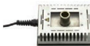
Les bains de soudure WSB 80 sont un outil pratique pour préparer des composants à souder. Les bains sont utilisés entre autre pour éliminer les particules de soudage étrangères aux extrémités des fils ou des fils de raccordement de circuits intégrés.
