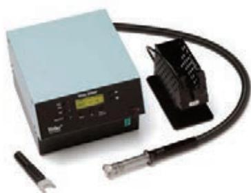
Turbine intégrée, par conséquent indépendante de l'air comprimé. Electronique de réglage numérique, afficheur LCD, opération manuelle ou automatique, interface RS 232 pour la commande via PC, connexion pour capteur externe, vide de buse maximale -0,6 bar, support de sécurité avec fonction Stop+Go, classe de protection 1.
