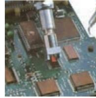
L'activation du vide est fait via un commutateur à doigt et l'étain à souder est recueilli dans un récipient collecteur. En utilisant des têtes de dessoudage CMS le composant est enlevé à l'aide du vide intégré. Le fer à air chaud (HAP) est utilisé pour le soudage avec pâte à souder ou pour le dessoudage. Dans ce cas, de petits composants peuvent être chauffés uniformément avec la buse standard; de plus grands composants en utilisant une buse appropriée.
