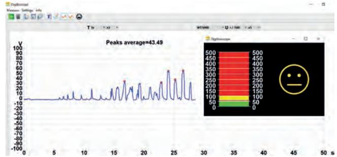
Das Walking Test-Kit dient überwiegend zur Messung von Personenauf Ladungen und deren grafischen Darstellung.
