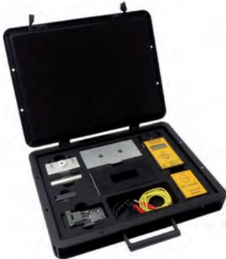
Mobiles, handliches Elektrofeldmeter mit Digitalanzeige zum Messen von elektrostatischen Feldern und elektrostatischen Aufladungen
